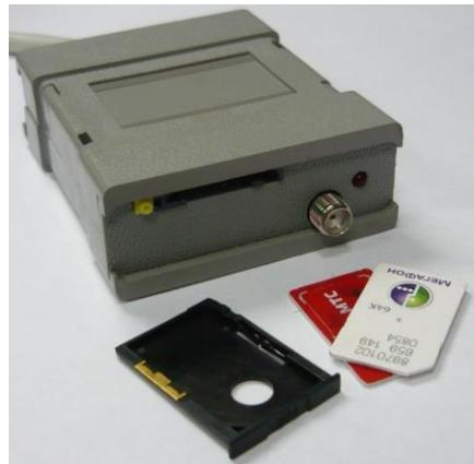
Контроллер выполнен в качестве отдельного блока, устанавливаемого в зоне радиовидимости GSM сети, питание по интерфейсному кабелю. В зоне со слабым уровнем сигнала базовой станции GSM сети обязательно подключение внешней антенны. Контроллер может быть встроен в устройство. В этом случае его работа полностью соответствует настоящей инструкции, за исключением недоступности визуального контроля за зеленым и желтым светодиодами.
