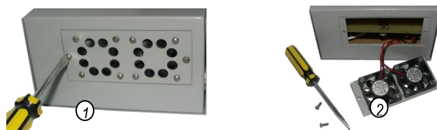
Замена вентиляторов охлаждения
