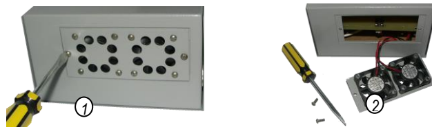
Замена вентиляторов охлаждения
