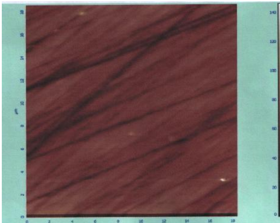
Рис. 8. Изображение топографии поверхности 40 Мб жесткого диска полученное прерывисто-контактной методикой после импульсной обработки. Амплитуда колебаний кантилевера составила 30 нм.
